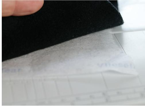
**Schritt 5:** Zum Applizieren verwendest du den Stick-/Stopffuß deiner Nähmaschine, du kannst aber auch den normalen Nähfuß verwenden, wenn du keinen anderen Nähfuß zur Auswahl hast. Unterlegt wird Stickvlies, ob ausreißbar oder auswaschbar ist reine Geschmackssache. Das Stickvlies erleichtert das Freihandführen des Stoffs.
